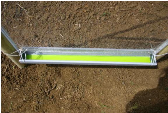
Abbildung 4.6: Beprobung mit Fensterfallen - oben links: aufgebauete Fensterfalle im Raps; oben rechts: Befestigung der Regenrinne an der Metallschiene, um ein Überlaufen bei starkem Wind zu vermeiden. unten links: Fängige Fensterfalle (Blütmischung vor dem Auflaufen im Mai)
