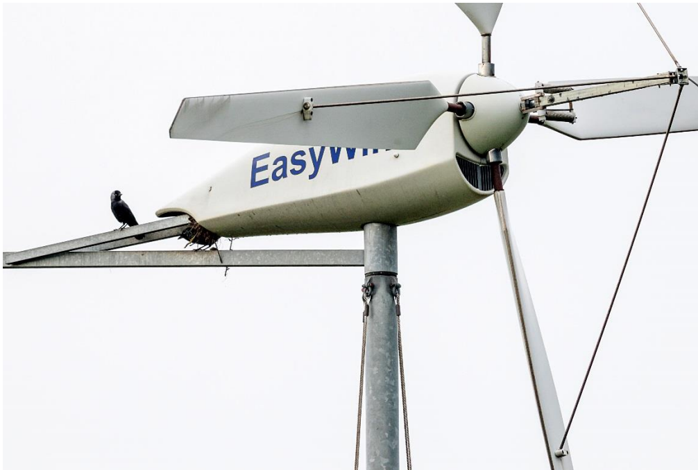
Abbildung 14: Dohlen beim Nestbau in der Gondel einer KWEA vom Typ EasyWind 6.0 (Standort Arle-watt). Foto: J. Sohler
