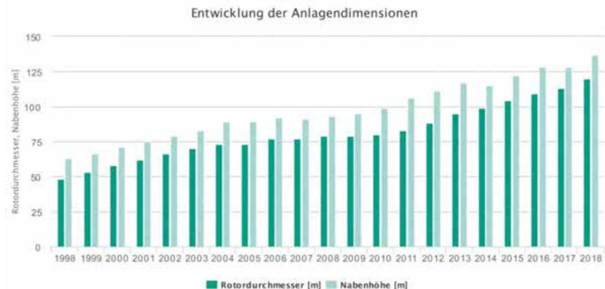
Abb. 11: Entwicklung der durchschnittlichen Rotordurchmesser und Nabenhöhen der zugebauten Windenergieanlagen von 1998 bis 2018 (Fraunhofer IEE 2018).
