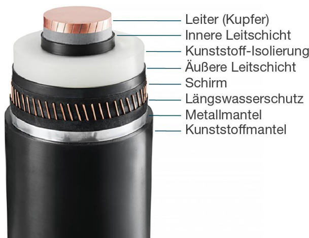
Abb. 1: Aufbau eines kunststoffisolierten Erdkabels
