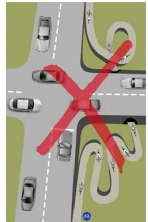
**Abb. 5.4: Zu vermeiden: Indirekte Führung von Fahrradwegen (Zeichnung: Darja Süßbier, verändert nach Schrammel & Zuckerstätter 1993; KfV)**
