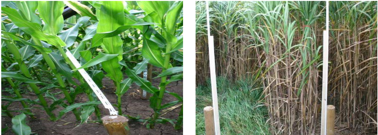
Abbildung 4.7: Probleme bei Fensterfallen - links: Umgeknickte Fensterfalle (Schwachstelle zwischen Holzpflock und Metallschienen); rechts: Reparierte Fensterfalle im Miscanthus. Verstärkung der Metallschienen durch Holzlatten
