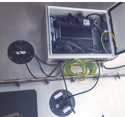
Akustische Fledermauserfassung in der Gondel: Der Aufnahmegerät (Rekorder) ist in einem sicheren Gehäuse untergebracht. Die beide schwarzen Scheiben zeigen die Position des Mikrofons (mit Testsignalgeber und Heizung, unten) und der Antenne für die Fernzugriffsfunktion (links) an.
